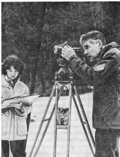
Измерение углов при триангуляции Фото В. Б. Обинякова
